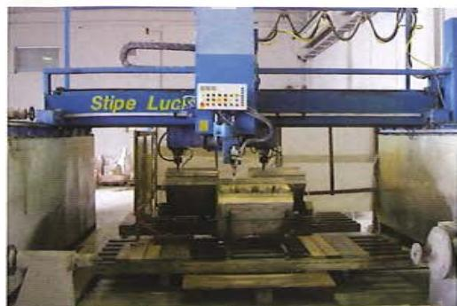
Geometrijski oblikovani kamen dalje se obrađuje pod velikim kompjuterski vođenim kopirnim strojem, koji prema modelu odmah obrađuje dva komada
