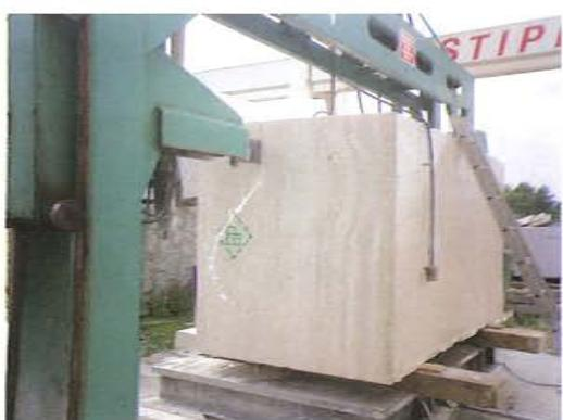
*Iz velikih blokova monolatom se dobivaju manji blokovi za potrebe nove komade, a u ukupnim dimenzijama po nacrtu*
