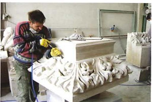
Konačnu obradu prema nacrtima i modelima radi klesar ručno, koristeći klasični i pneumatski alat
