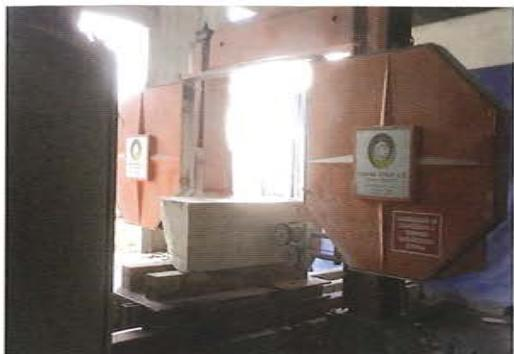
Kameni blok odgovarajućih brutto dimenzija oblikuje se kompjuterski vođenim strojem do potrebnog oblika sa masom za izradu kamene plastike
